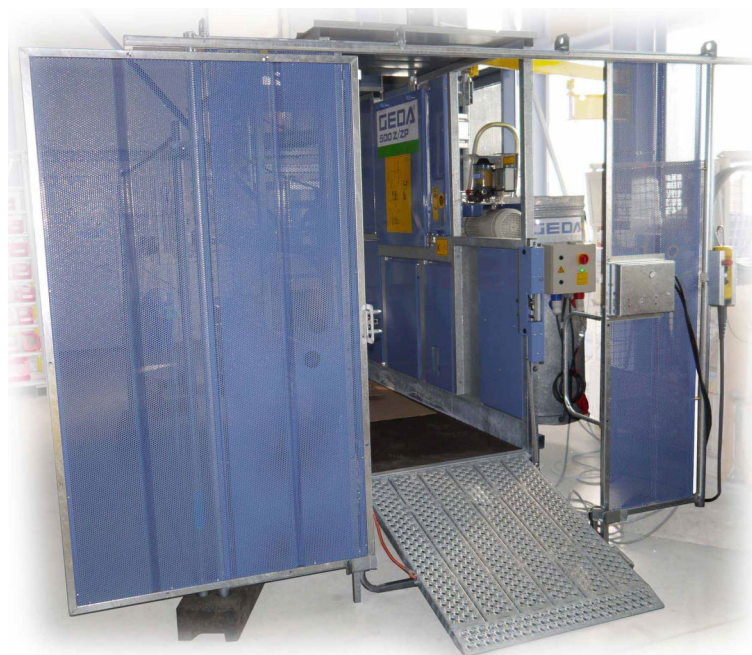
III. 22: Porte coulissante du dispositif de protection au sol ouverte
