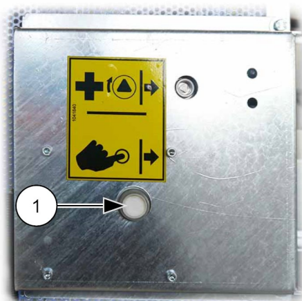
III. 19: Déverrouiller la serrure de la porte coulissante
