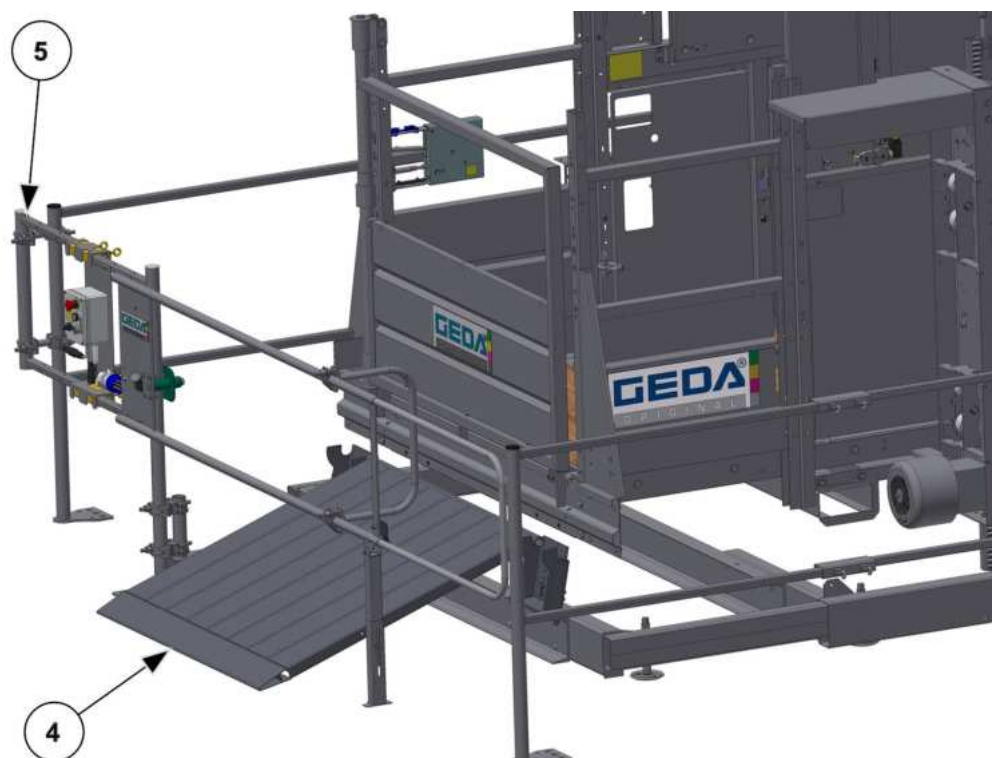
III. 50: Rampe d'accès à la plateforme au départ de la station au sol
