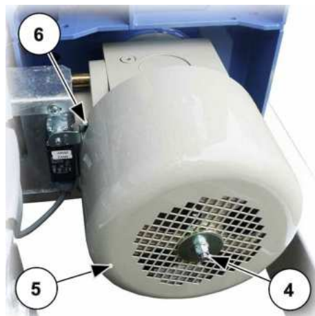
III. 104: Dispositif de freinage avec interrupteur de fin d'urgence
