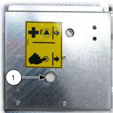
III. 40: Déverrouiller la serrure de la porte coulissante
