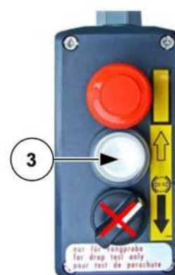
III. 103: Commande des essais de freinage
