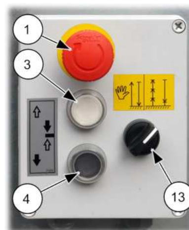
III. 79: Commande au sol pour le dispositif de protection (AUTOMATIQUE)
