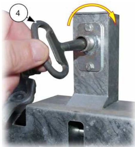
III. 74: Déverrouillage d'urgence de l'encagement d'accès sécurisé
