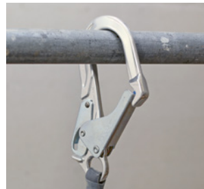
5 et 6 Les mousquetons doivent être fixés verticalement et ne pas être sollicités transversalement.
